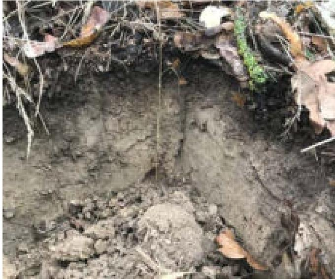
Abb.: Bodenprofil Ranker, Braunerden (flachgründig)
